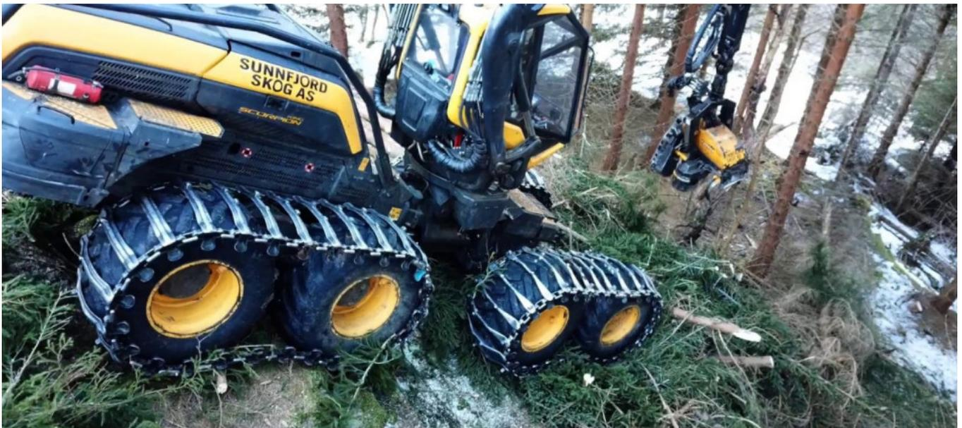
Abb. 8: Die Ernte erfolgt zwar maschinell, aber auf gefrorenem Boden und Matten aus Ernteresten.
