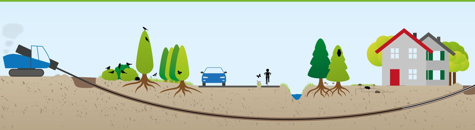
Abb. 3: Grabenlose Rohrverlegung mittels Horizontalpülbohrverfahren
