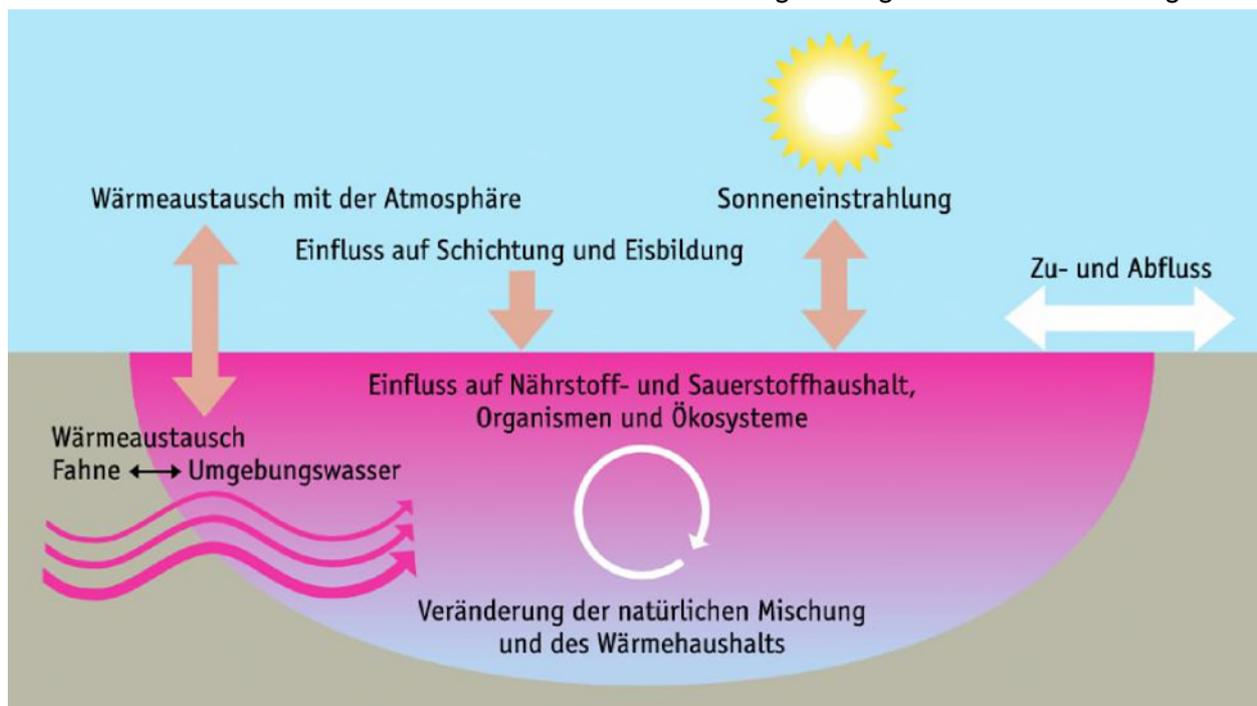
Abb. 4: Prozesse in Seen, welche durch die Einleitung erwärmten Kühlwassers beeinflusst werden können. (Quelle Lanz et al. 2021), bearbeitet.
